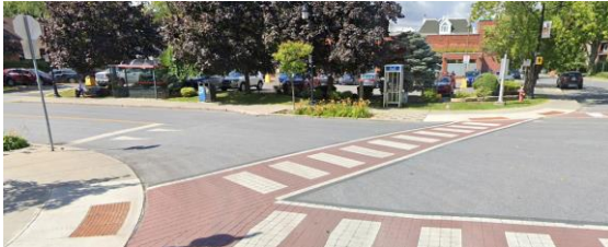
Photo 6.8 : Plaques podotactiles – Intersection de l’avenue Victoria et du boulevard Desaulniers
