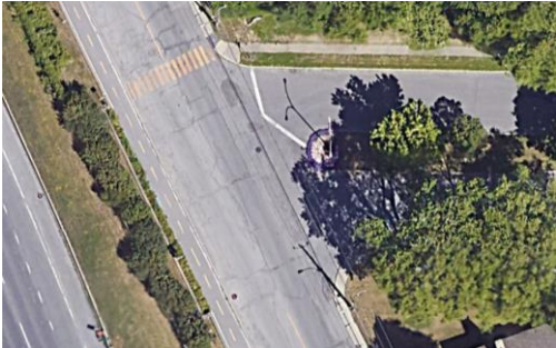
Photo 5.8 : Lignes d’arrêt non droites – Intersection de la rue Riverside et du boulevard Montrose
