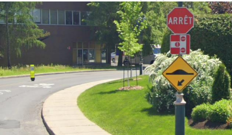
Photo 5.11 : Panneaux de catégories différentes sur un même support – Intersection des rues Upper-Edison et Terroux
